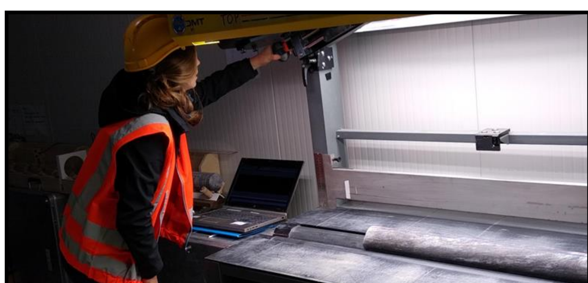
Esecuzione di una scansione completa a 360 gradi su una carota
